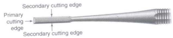
تصویر ۶-۴ طرح تیغه چیزل که نشان دهنده لبه های برنده اولیه و ثانویه است
