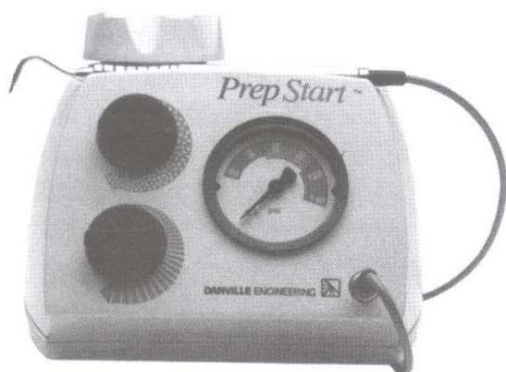
تصویر ۱۱ نمونه‌ای از دستگاه air-abrasion رایج برای برداشت ضایعات و رنگدانه‌های مینایی، پاکیزه سازی شیارها و فرورفتگی‌ها برای کاربرد سیلات، یا ایجاد خشونت در سطحی برای اتصال با مواد چسبیده یا سمان.
